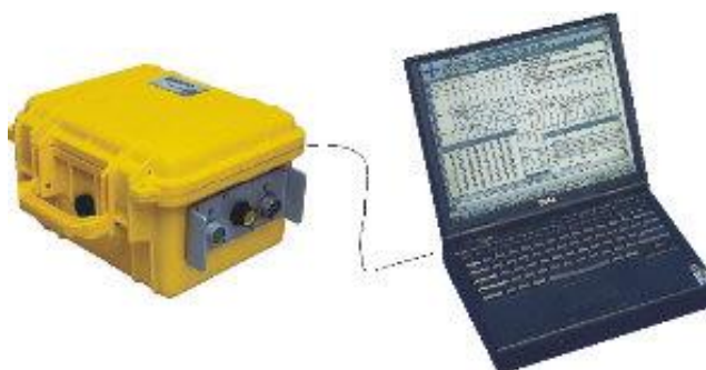
Fot. 4 Rejestrator Geode wraz z przenośnym komputerem [9]
