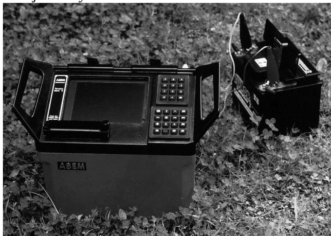
Fot. 3 Przenośny, wielokanałowy rejestrator sejsmiczny Terraloc MK6 [4]
