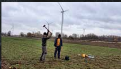
Farma wiatrowa – badania sejsmiczne w rejonie budowy nowych turbin
