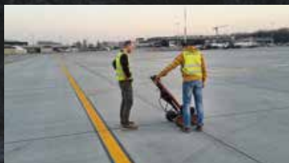
Port Lotniczy Kraków Balice – badania georadarowe nawierzchni drogi kołowania
