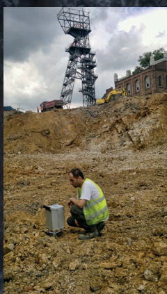
Kopalnia węgla kamiennego Katowice – badania grawimetryczne w rejonie płytkiej eksploatacji
