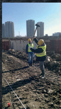
Kopalnia węgla, Śląsk – badania sejsmiczne podłoża obiektów wielkokubaturowych
