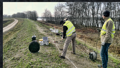
Obwałowania Wisły, Płock – badania sejsmiczne ciągłości przesłon przeciwfiltracyjnych DSM
